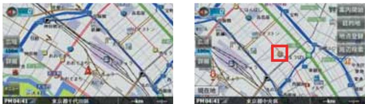
現在画面で地図にタッチします。タッチした地点が画面の中央となり、地図が移動します。移動後は画面右にQuick Startボタンが表示されます。
