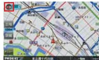
ヘディングアップ表示は画面の上方向が自車の走行方向になるように地図を回転して表示します。(自動的に回転し表示します。)
